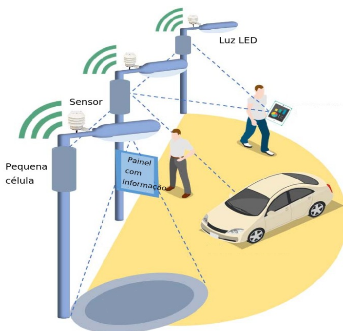
Ilustração 4: Esquema de um poste de luz inteligente
